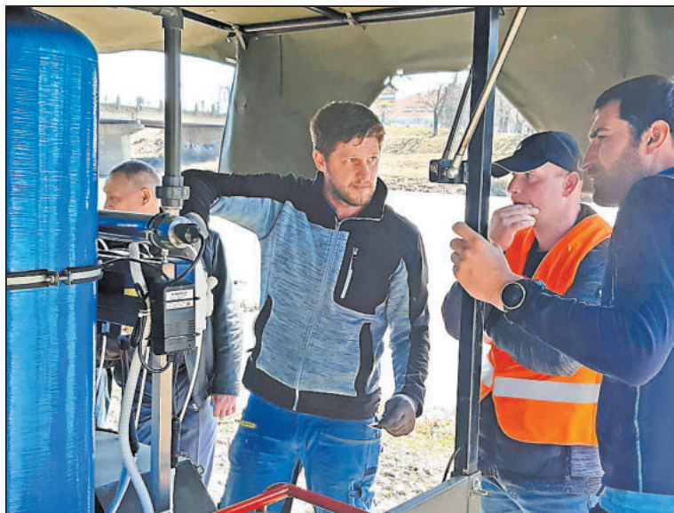
FILTRUJE říční vodu a mění ji na pitnou. Česká úpravna je mobilní a lze ji okamžitě zprovoznit. Foto: archiv
