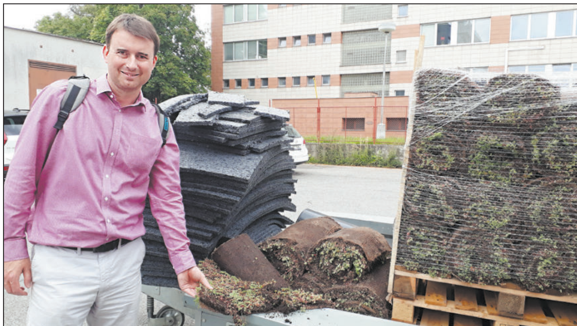
PÁSY se zakořeněnými sukulenty představuje energetický specialista Michal Bačovský. Smotané „koberce“ stačí položit a zalít. Zelené střechy uvidíme z proskleného schodiště polikliniky.
