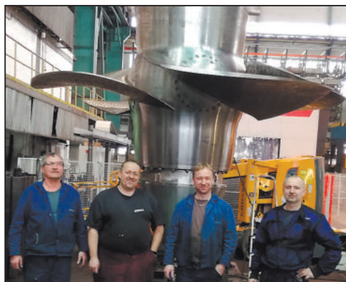
PARTA žďárských nástrojářů, kteří prováděli závěrečnou montáž oběžného kola Kaplanovy turbíny pro vodní elektrárnu Kamýk. Foto: archiv Žďas
