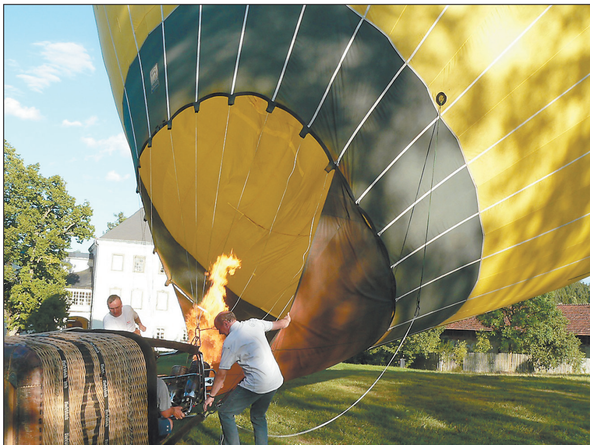
NAFUKOVÁNÍ balónu, ve kterém se za chvíli vydáme k nebi. Pojme 3.700 kubíků horkého vzduchu a za hodinu letu spálí 200 litrů propanu.
