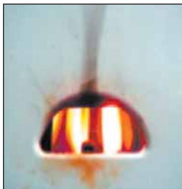
ŽLUTÝ PLAMEN v důsledku nedokonalého spalování.
