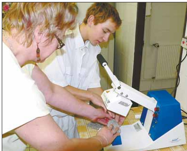
V DOMĚ KLIDNÉHO STÁŘÍ již pracovníci prádelny značí svršky novou technologií. Speciální přístroj dokáže bezpečně zalisovat jmenovku i do jemných punčoch.
