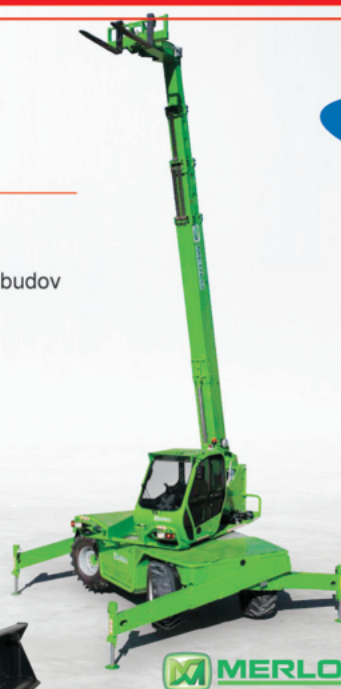
Provádíme služby strojem MERLO ROTO 40.21.EVS Zdvihová výška: 21 m, nosnost: 4000 kg
