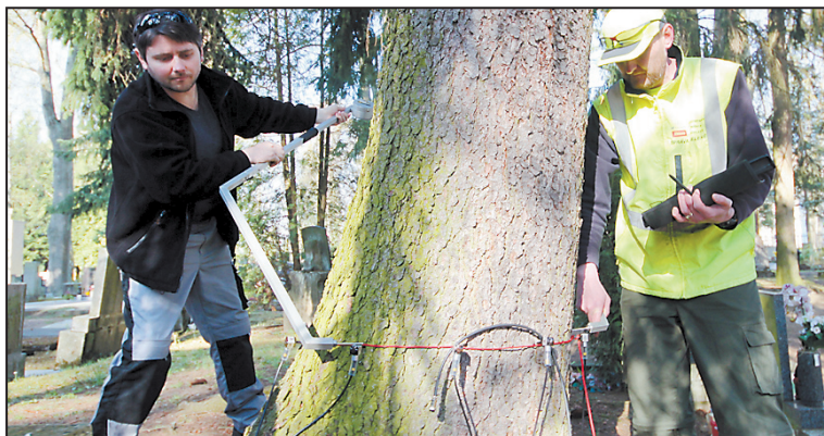
NOVÝ přístroj v rukou arboristů - akustický tomograf - zkoumá dutiny stromů a rozhoduje, zda je nutno strom pokácet. Foto: archiv MMJ
